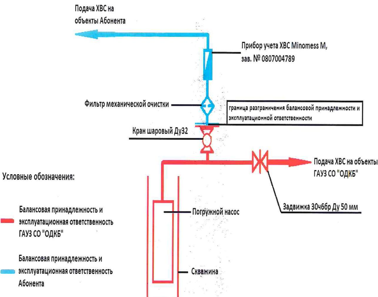
Схема разграничения балансовой принадлежности и эксплуатационной ответственности по водопроводным сетям
